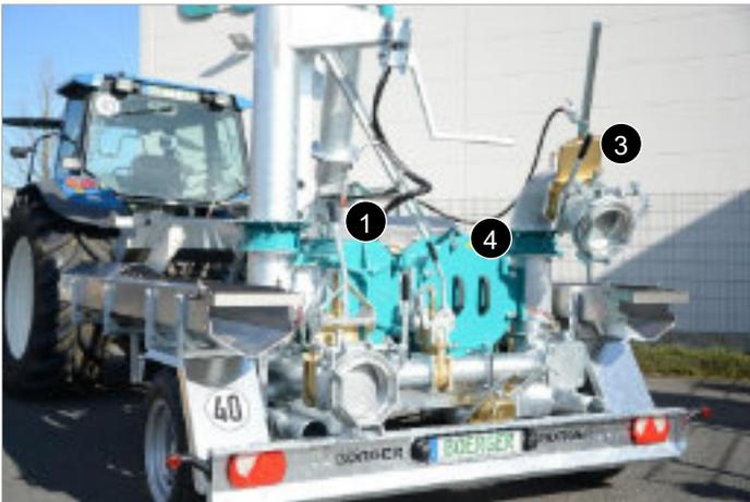
Die **Hochleistungs-Drehkolbenpumpe [1]** BLUEline EL 1550 befüllt die Fässer mit bis zu 9.300l/min. Eine leicht austauschbare Gehäuseauskleidung schützt das Pumpengehäuse vor Verschleiß. Die Pumpe wird über die Gelenkwelle des Schleppers angetrieben. Das **2-Gang Schaltgetriebe [2]** ist für zwei Zapfwellengeschwindigkeiten (540 & 1.000 UpM) ausgelegt. Dadurch kann die Fassfüllstation flexibel betrieben werden.
