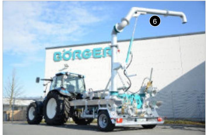
Der **Befüllgalgen [6]** ist über die Hydraulik des Schleppers hochfahr- und schwenkbar. Auf Wunsch liefern wir zusätzlich eine Funkfernbedienung.
